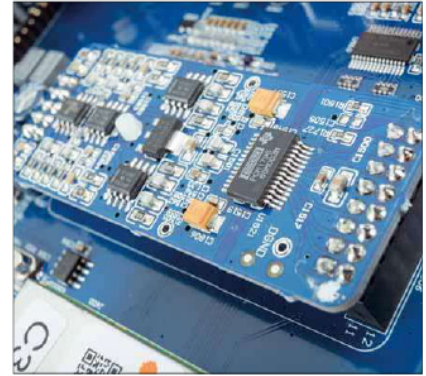
Anders als bei einigen bekannten Systemen der C-Serie wird im C 338 wieder ein separater DAC-Chip verwendet
