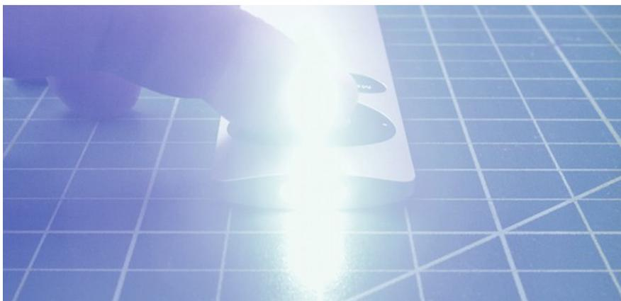
*Ci-dessus: télécommande infrarouge Apple photographiée à l'aide d'un appareil photo numérique. Bien que l'émetteur soit assez brillant et que la fréquence émise ne soit pas loin de la partie rouge du spectre visible, il est complètement invisible à l'œil.*
